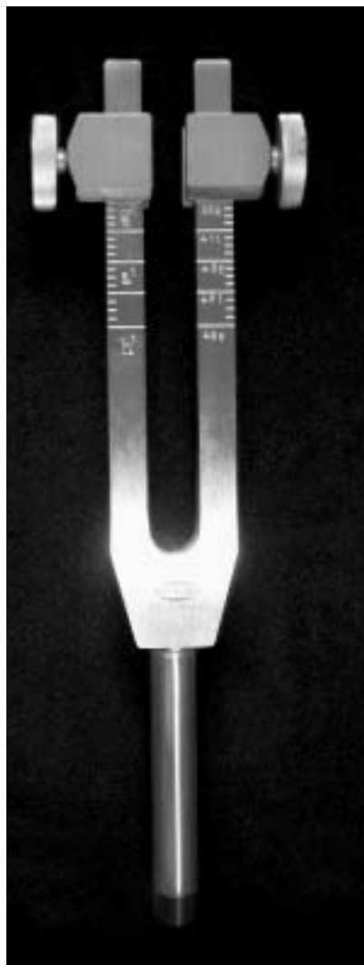
Diapason regolato per l'emissione della nota SOL 388 [Hz].
