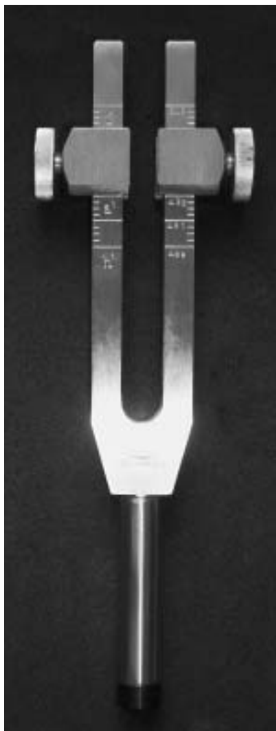
Diapason regolato per l'emissione della nota LA 435 [Hz].
